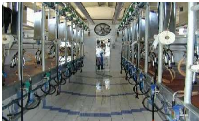
شكل رقم (182) يوضح صالة للحلب الآلي وقد روعي في تصميمها الشروط الصحية الجيدة.
