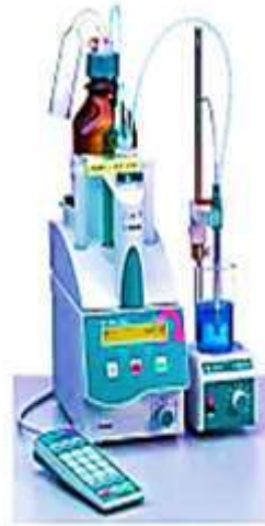
الشكل (٣): (جهاز المعايرة بقياس الجهد): يُستخدم لمراقبة تغيرات الجهد أثناء إضافة المُعايير، مما يتيح تحديد نقطة التكافؤ بدقة.
