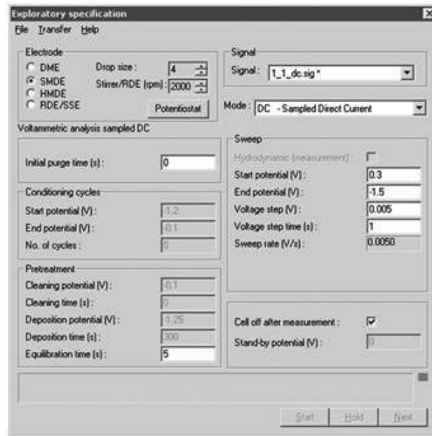
الشكل ١. إعدادات الجهاز للقياس في وضع التيار المستمر
