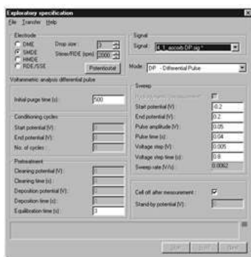
شكل ٢: إعدادات الجهاز للقياس في وضع النبضة التفاضلية (DP mode).
