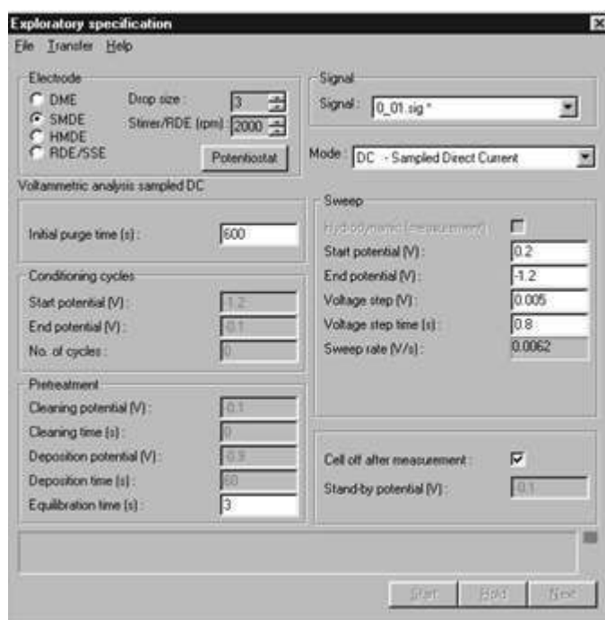
شكل ١: إعدادات الجهاز للقياس في وضع التيار المستمر (DC mode).
