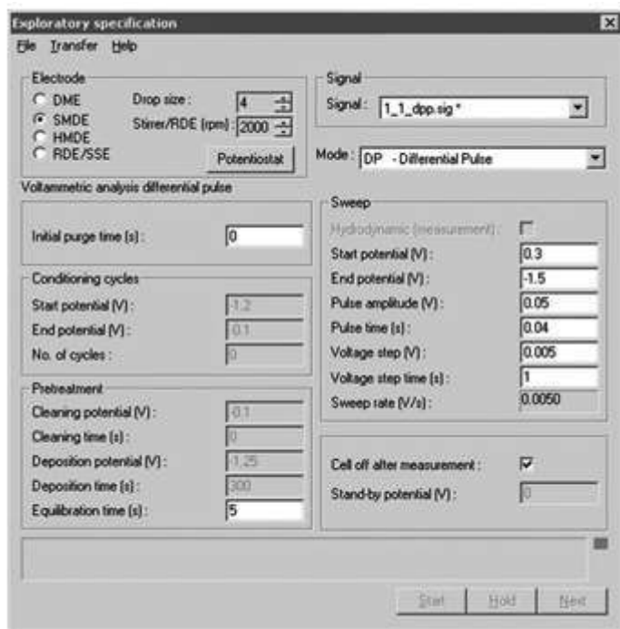
الشكل ٢. إعدادات الجهاز للقياس في وضع DP
