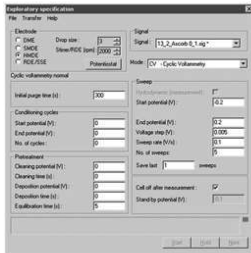
الشكل (٥): إعدادات الجهاز لقياس حمض الأسكوربيك
