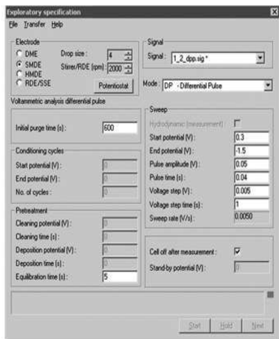
شكل ٥: إعدادات الجهاز للقياس في وضع النبضة التفاضلية (DP mode).
