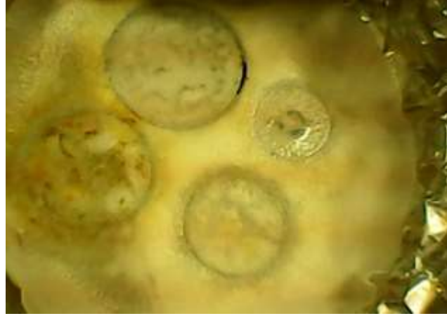
الشكل ٢: صور العملات على ورقة الترشيح الناتجة عن التحليل الكهربائي لـ KI.
